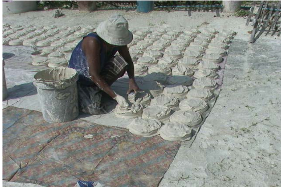
ภาพที่ 32 การทำดินสอพองแผ่นกลม
