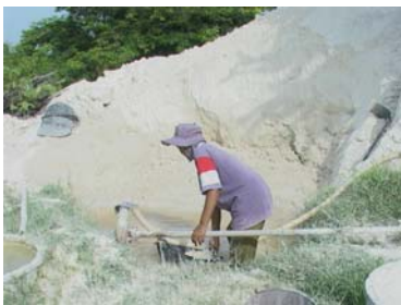
ภาพที่ 17 การฉีดน้ำละลายดิน
