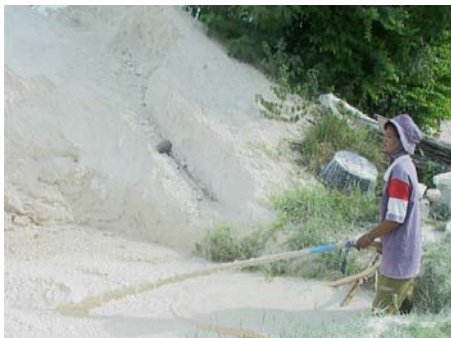
ภาพที่ 24 ฉีดน้ำละลายดินไหลลงบ่อตาก
