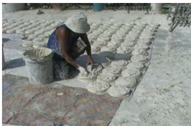
ภาพที่ 19 การทำดินแผ่น
