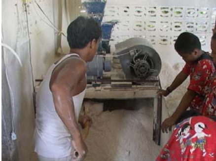
ภาพที่ 37 การโม่และการบรรจุดินสอพองผง
