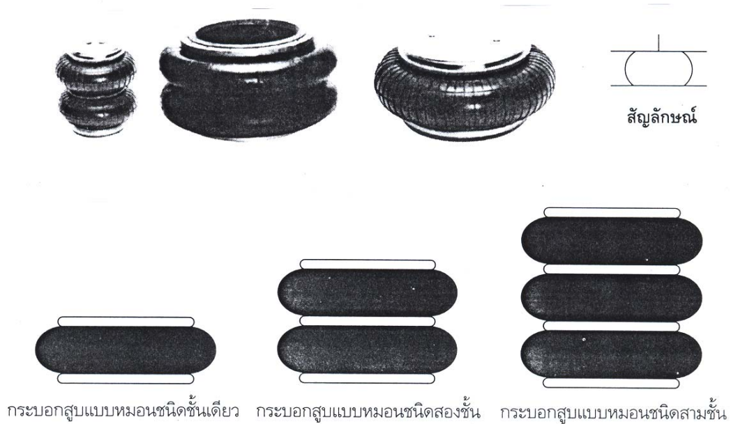
ภาพที่ 3.5 ครอบอกสูบแบบหมอนแบบต่าง ๆ ที่มา (ณรงค์ ต้นชีวะวงศ์, 2547, หน้า 129)
